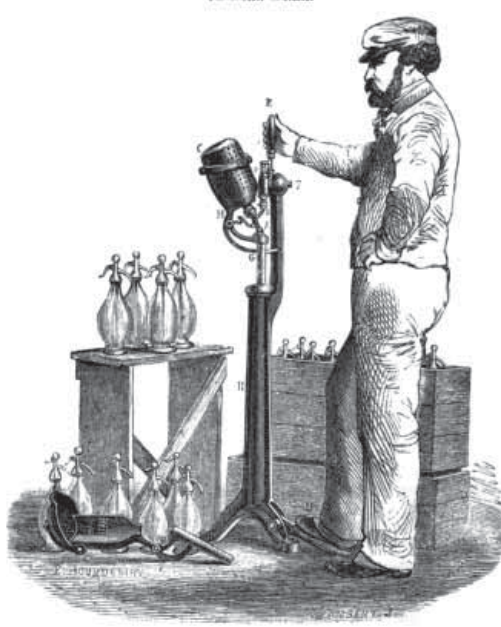
9-10. kép Szifontöltés a 19. század második felében. (Hermann-Lachapelle, J. – Glover, Ch.: Des boissons gazeuses aux points de vue alimentaire, hygiénique et industriel. Guide pratique du fabricant & du consommateur. 3 e éd., E. Lacroix, Paris, 1867. után)
