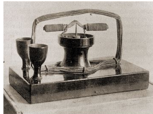
4. Sokszorozó tekercsben áramváltással forgó villamdelej: Jedlik forgonya (1830)
